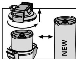
3. Снять с нового картриджа защитный колпачок. Извлечь старый картридж и заменить его на новый
