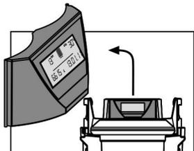
5. Электронный дисплей извлечь (вверх) из головной части фильтра
