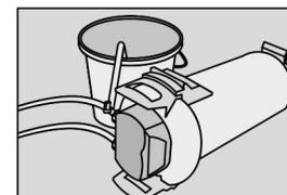
8. ПРОМЫВКА/ЗАПУСК В ЭКСПЛУАТАЦИЮ. Промывка №1 – фильтр ПОЛОЖИТЬ! ВНИМАНИЕ! Фильтры 1200 CLEAN и 1200 CLEAN EXTRA – единственная промывка и в вертикальном положении
