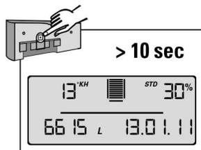
6. На задней панели электрон. дисплея нажать кнопку (> 10 сек): загрузятся параметры, установленные при первичном монтаже фильтра, и обновятся ресурс, bypass, текущая дата. Временной 12-месячный лимит установится автоматически.
