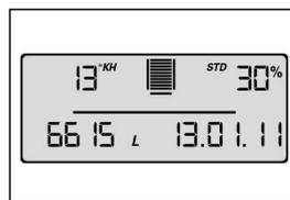
12. ВНИМАНИЕ! Для фильтров с эл. дисплеем промывку повторять до тех пор, пока на экране не отобразятся величины ресурса (L), bypass (%), текущая дата и гистограммы
