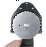
Установите защитную пластину ножа. При установке сначала совместите паз пластины на ее левой стороне со штифтом ножа. • Затем совместите паз пластины на ее правой стороне со штифтом ножа. • Убедитесь в том, что регулировочный винт находится на своем месте в соответствующем отверстии защитной пластины. Затем опустите защитную пластину и убедитесь в ее правильном положении.
