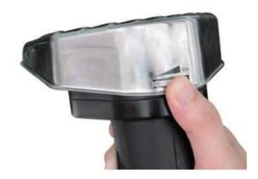
Толщина реза может варьироваться от 0,5 до 8мм. Попорот регулировочного винта налево приводит к уменьшению толщины реза, наоборот поворот винта направо приводит к увеличению толщины реза.
